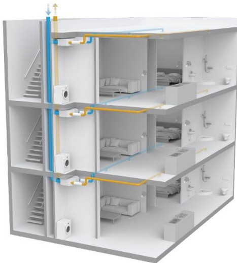
Vue d'ensemble du système de ventilation HRC-OptiAir-BE
